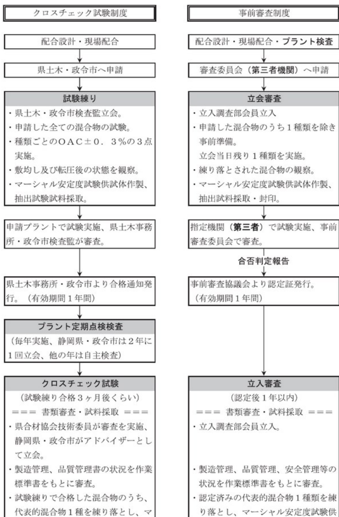
図－１．クロスチェック試験制度・事前審査制度の比較
